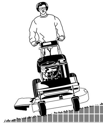
Usted podría sufrir lesiones graves si utiliza esta unidad en una pendiente demasiado inclinada. El uso de la unidad en una pendiente demasiado inclinada donde no tenga una base de apoyo y tracción de la unidad (y control) adecuados puede causar pérdida de control, deslizamientos y posible vuelco.
