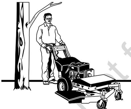
Este equipo tiene muchas piezas móviles que pueden lesionarlo a usted o a otra persona. Sin embargo, si permanece en la zona del operador (el área detrás de las manillas y los controles), y sigue las reglas de seguridad en el manual del operador, es seguro operar la unidad.
