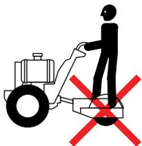
NO utilice un Sulky, ni ninguno otro tipo de plataforma de remolque del operador en esta máquina ya que excede el límite de carga de la transmisión. Podrían presentarse daños permanentes a la transmisión, los cuales NO están cubiertos bajo la garantía.
