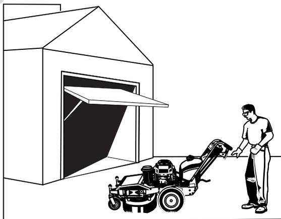
Solo opere esta unidad en exteriores y lejos de áreas sin ventilación como dentro de garajes o remolques cerrados. El motor emite gas de monóxido de carbono venenoso y la exposición prolongada en un área cerrada puede resultar en lesiones graves o muerte.
