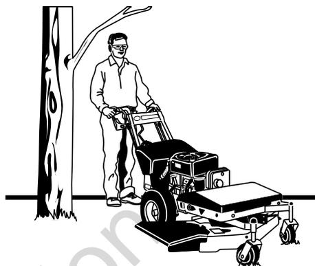
Este equipo tiene muchas piezas móviles que pueden lesionarlo a usted o a otra persona. Sin embargo, si permanece en la zona del operador (el área detrás de las manillas y los controles), y sigue las reglas de seguridad en el manual del operador, es seguro operar la unidad.
